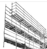
Ponteggio metallico fisso
